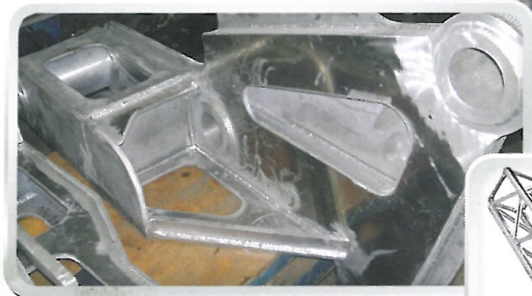
SALDATE DI PARTICOLARI MECCANICI IN ALLUMINIO
